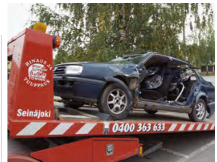
12-tonnisen Volvo-alustan liukulavalaiteisto nostaa kolari-autot hetkessä lavalle.
