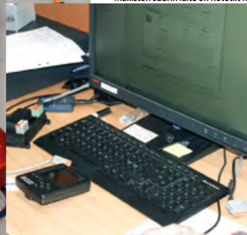
Rototiltin ohjainyksikköön asennetaan asiakkaan haluamat ohjaintiedot tietokoneella.
