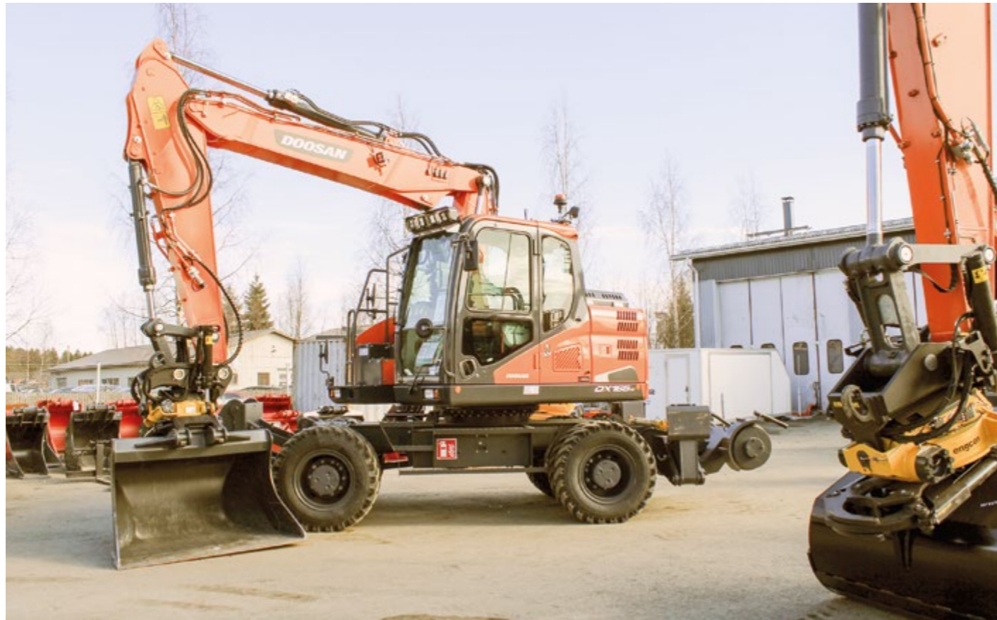
Doosanin ratavarustelun on tehnyt Kouvossa toimiva Asfaltti-Systems Oy, joka varustaa 10-15 konetta vuodessa ratatöihin.
