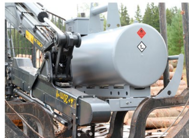
Pankkasäiliö on suunniteltu kuljetettavaksi kuormatruktorin pankkojen päällä karikatuki karikatappien takana. Näin vapautuu kuormatruktorin varsinainen kuormatila nosturille kuljetusasentoon.
