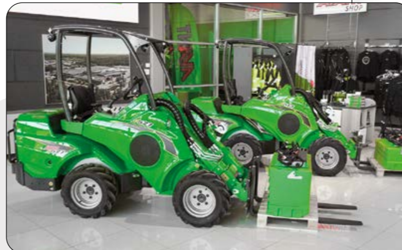
Lähipäästötön sähkökuormaaja on ylivoimainen sisätiloissa, kuten purkutöissä työskenneltäessä.
