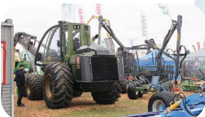
Prosilva S5 oli esillä messuilla. Koneen paino on 18,5 tonnia moottorin teho 187 kilowattia.
