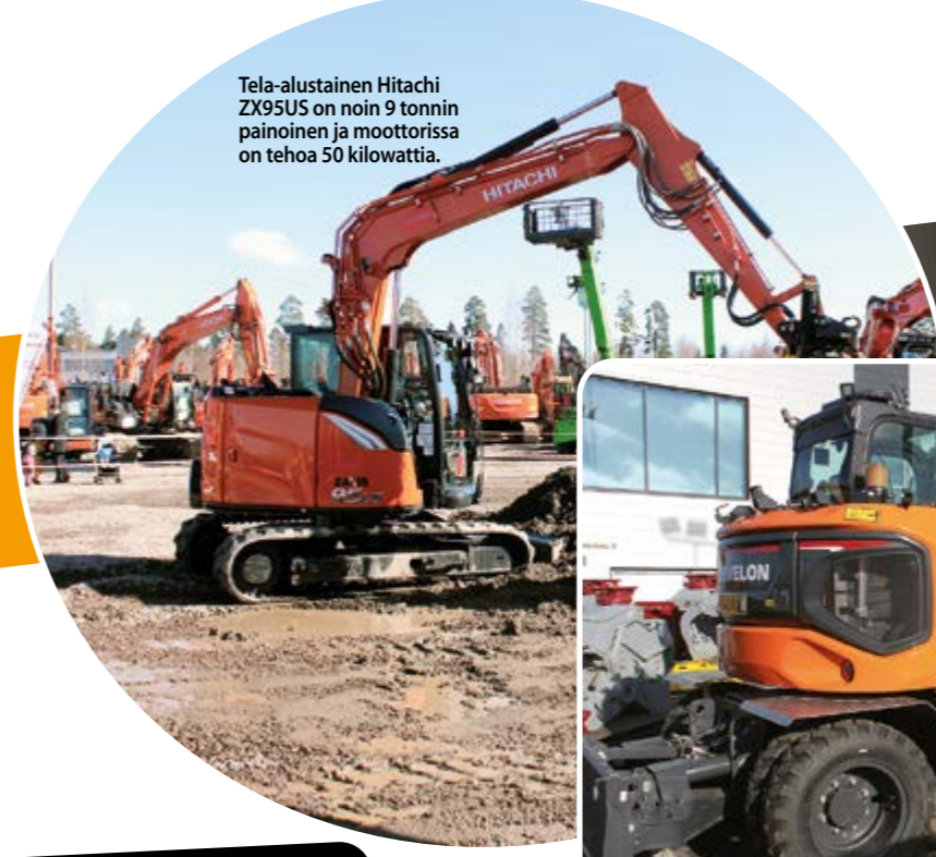
Develon DX 100W on uusi pyöräalustainen malli. Koneen paino on noin 11 tonnia ja moottorin teho on 75 kilowattia. Toisena uutena mallistoa täydentää telaalustainen Develon DX 85R.
