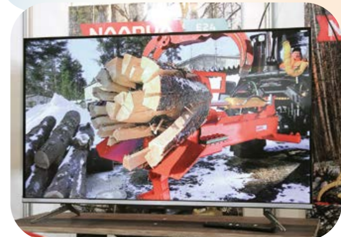
Pentin Pajan uusin versio H100 halkaisukoneesta. Laitte tekee 2 minuutissa 1,5 kuutiota klappeja. Klappipituus on nyt 110cm ja rungon halkaisija saa olla 50cm, kertoi Mikko Häikiö.
