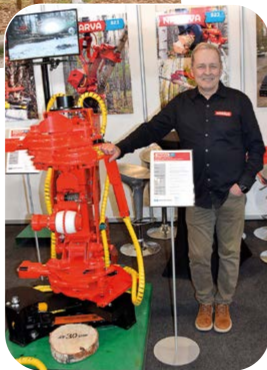
Mikko Häikiö Pentin Paja Oy:stä esitteli tuhannetta energiapuukouraa. Se oli malliltaan S23, kevyt sykeharvesteri sahakatkaisulla 5-8 tonnin kaivinkoneisiin tai traktoreihin. Kuva Keijo Rajaniemi.
