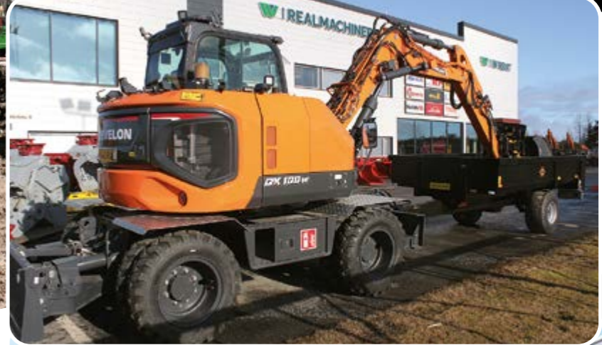
Develon DX 100W on uusi pyöräalustainen malli. Koneen paino on noin 11 tonnia ja moottorin teho on 75 kilowattia. Toisena uutena mallistoa täydentää telaalustainen Develon DX 85R.
