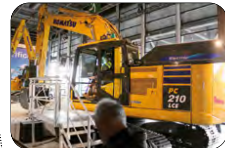
Komatsu PC 210LCE-11 Electric esitellyssä sisähallissa. Koneen paino on 24,4 tonnia. Koneen teho on 123 kilowattia. Akut ovat 451 kilowattia.
