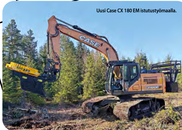
Kääntökehän ja telojen väliin leikattiin pidempi ja leveämmälle ylettyvä korokepala. Myös telojen yläruullat ovat vahvemmat ja niitä nostettiin korkeammalle.
