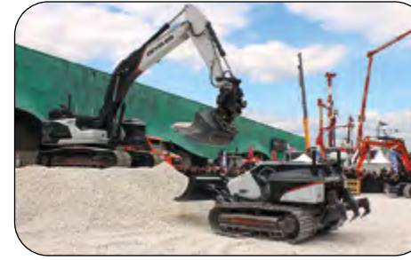
Develon Concept X2 koneet olivat Develon 225 kaivukone ja Develon 100 puskutraktori. Koneissa ei ole ohjaamoja ja ne toimivat itsenäisesti tai kauko-ohjauksen avustamana.
