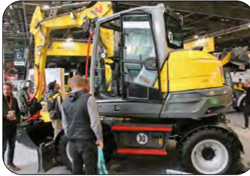
Uusi Wacker Neuson EW100-2 on 10 tonnin painoinen pyörälustainen kaivukone.
