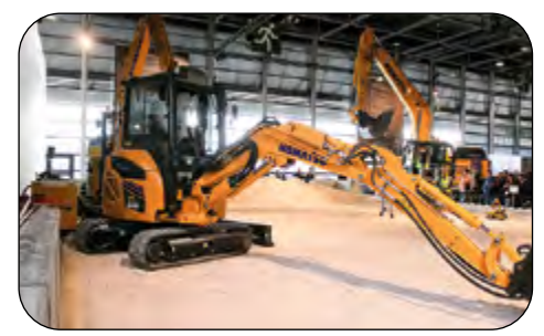
Komatsu PC33E-6 Electric on sähkötoiminen tela-alustainen 3,7 tonnia painava kaivukone. Akku on Komatsun 35 kW litium-ioni akku. Sähkomoottorin teho on 17,4 kW.
