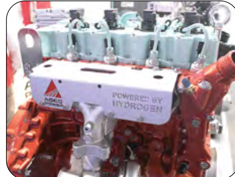
Agco Powerin Linnavuoren tehtaalta oli vetymoottori esillä. Tommi Puomisto kertoi, että hyvin toimii, mutta vedyn varastointi on ongelma. Vetyä tarvitaan paljon suhteessa dieseliin ja se ei tahdo pysyä säiliössä, vety vuotaa vähitellen materiaalin läpi pois.
