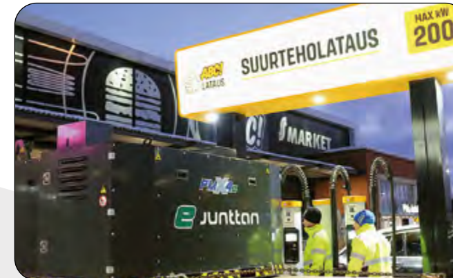
Akkukapasiteetiltaan 392 kWh ja 528 kWh akkujen pikalataus onnistuu myös CCS-pistokkeesta julkisella suurteholatausasemalla.
