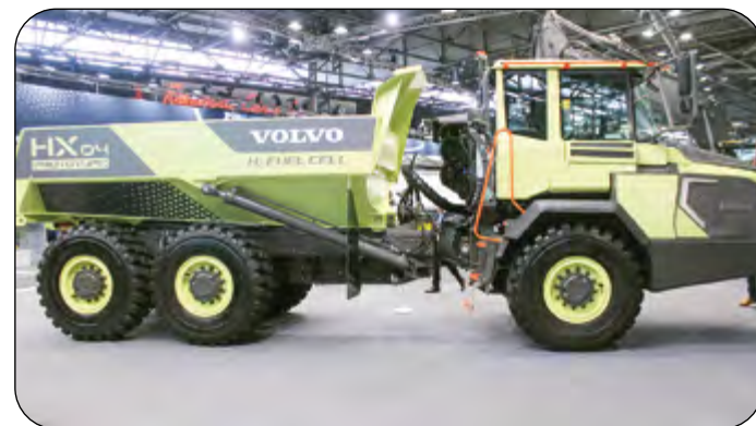
Volvo HX 04 on vetydumpperi, jonka hyötykuorma on 20 tonnia ja kokonaispaino 38,5 tonnia. Polttokennoteho on 100 kilowattia. Akut ovat 600 voltisia ja 2x50kwh. Sähkötönnörin kokonaisteho on 200 kW.
