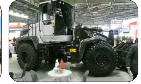
Turkkilaiset Curukova maarakennuskoneet olivat esillä messuilla. Kuvassa Curukova 940 pyöräkuormaaja. Koneessa on 129 kilowatin 6-sylinterinen Cummins moottori. Painoa koneella on 14 tonnia.
