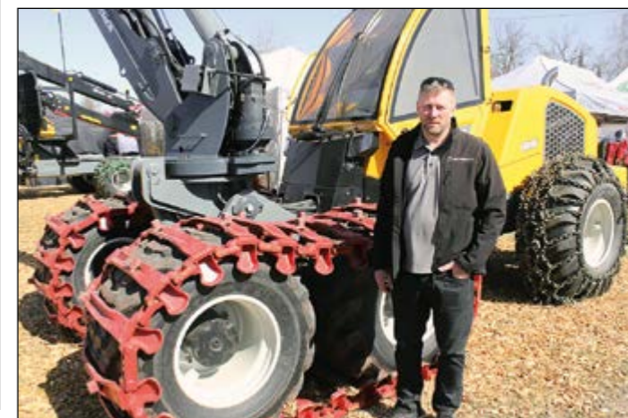
Lisää ulottuvuutta. HR56:ssa on Logmerin kymmenmetrinen puomi, mikä tuo juuri ratkaisevat metrit lisää ulottuvuutta.
