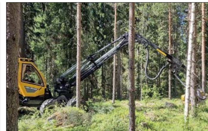
Lisää ulottuvuutta. HR56:ssa on Logmerin kymmenmetrinen puomi, mikä tuo juuri ratkaisevat metrit lisää ulottuvuutta.
