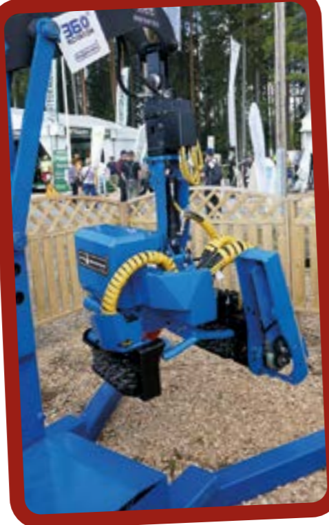
Kone-Ketosen patentoima 360° Plus -rotaattori pyöritti K-51 kouraa näyttelyssä herkeämättä. Pyörimisvoimaa on jopa 1050 Nm 100 baarin paineella, vaikka kaikki hydraulikkaletkut, kantokäsittelyaine ja urea kulkevat ympäröivän rotaattorin läpi.
