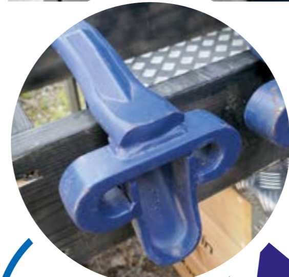
Ruotsalaisen KoppomMaskin XL Traction -telakenkien C-lenkeissä on työstetyt sisäpinnat, jotka joutuvat käytössä kaikkein kovimmalle kulutukselle. Työstön ansiosta telan kiinnityskohta kestää enemmän kulutusta eikä lähde kääntymään kuten taivuttamalla muovattu teräs.
