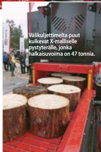
Feed 900 syöttöpöytä kykenee käsittelemään tukkipöydältä tulevia 90 cm paksuja pöllejä.
