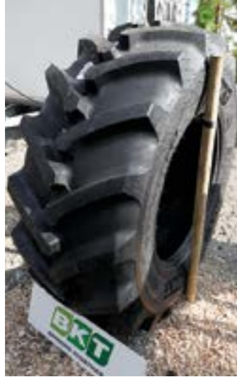
BKT Forest Max 540/65R8 on traktoriin tarkoitettu metsärenkas. Yleensä kun metsäkäyttöön suunniteltu riparengas on ristikudosvahvistainen, niin tämä on teräsvahvistettu vyörengas, jolla voi ajaa maantielläkin.
