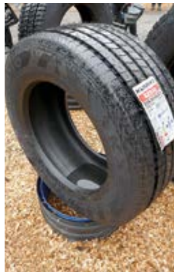
Kumho KXS10 on uutuuskoon 335/50R2 rengas, joka on tarkoitettu lavettityyppisten kuorma-autojen takimmaisille ohjaaville akselille. Rengas sopii hyvin ympärivuotiseen käyttöön.
