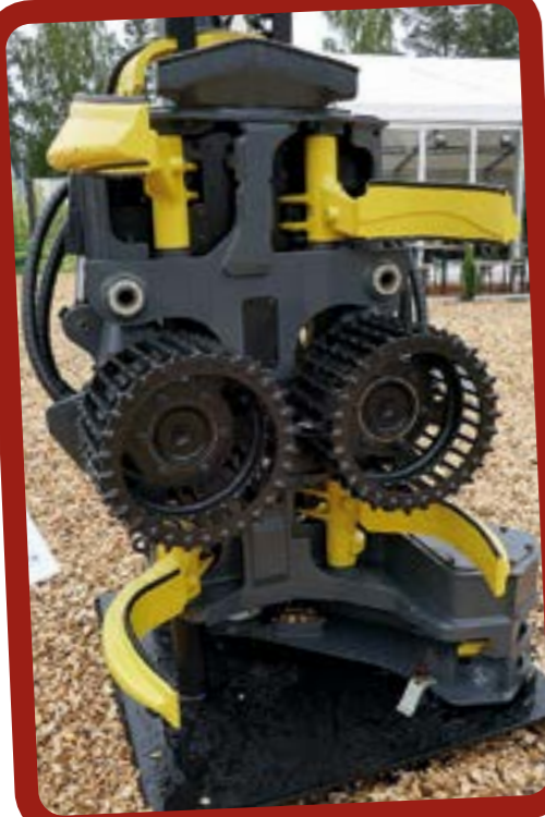
John Deeren H216 korvaa aiemman H270-harvesteripään. Kaksirullainen H216 on tarkoitettu lehti- ja havupuiden käsittelyyn ison kokoluokan harvestereilla. Esimerkiksi 1270H:lla puomin ulottuma on 8,6/10 metriä.
