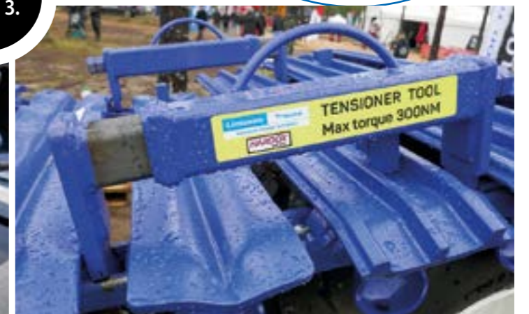
Metsätyö Oy uusi CoverB-OF yhdistelmä- eli sekatelamalli on yhdistelmä kahdesta eri telakengästä, OF:sta ja CoverB:sta
