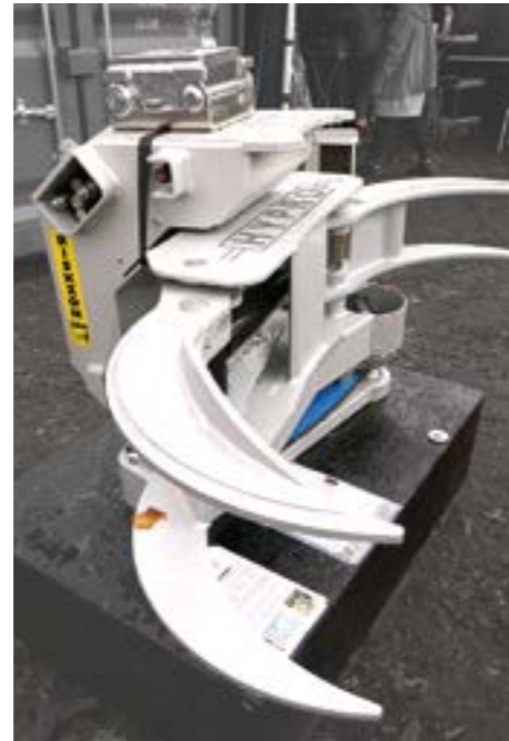
Hypro FG60FA kaatokoura vaatii vain kahden hydrauliletkun kiinnityksen. Laite painaa vain 350 kg mutta kykenee katkaisemaan jopa 60 cm paksun puun.
