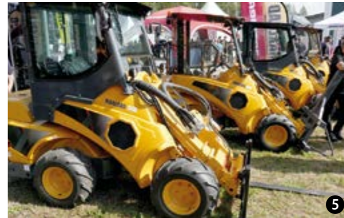
Kuva 1. Lännen-kaivurikuormaajan kaivulaite on korvattu työkonurungolla, johon saa esimerkiksi ison hiekoittimen, kun edessä on aura. Kaivulaiteen vaihto käy muutamassa tunnissa avaamalla letkuliittimet ja neljä tappiasekä sen tilalle kiinnittämällä työkonurungon ja lisävastapainon.
