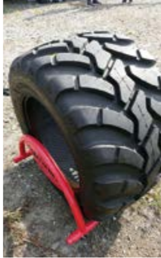
Kaivinkonekäyttöön suunniteltu nappularengas Alliance 339 on valmistettu erityisestä leikkausta ja lohkeilua kestävästä kumiseoksesta.
