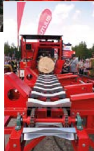
Feed 900 syöttöpöytä kykenee käsittelemään tukkipöydältä tulevia 90 cm paksuja pöllejä.
