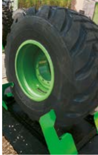
Forest King F2 metsäkoneen renkaan muotoilu, vahvistetut olkapäät ja suojaava pintakuviointi on suunniteltu teloja tai ketjuja käyttäville ajajille. Koko on 30.5".
