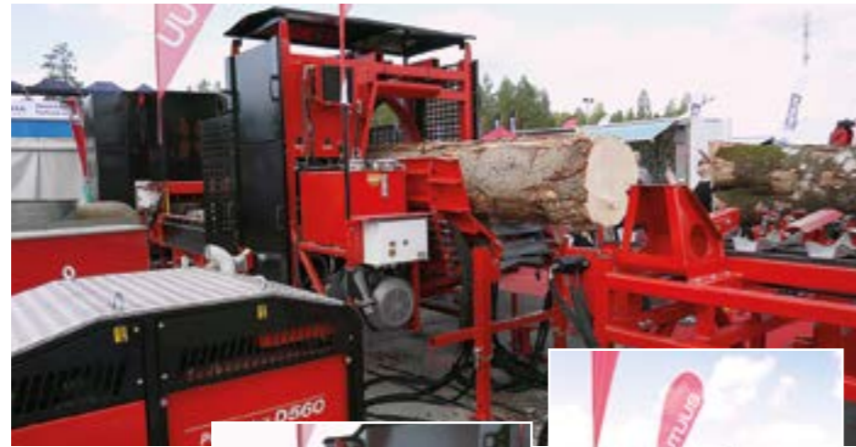
TP Silvan katseenvangitsija näyttelyssä oli ulkomaa markkinoille suunnattu XL Conveyer-klapitehdas, joka käsittelee tukkipöytä paksut puut valmiiksi klapeiksi.
