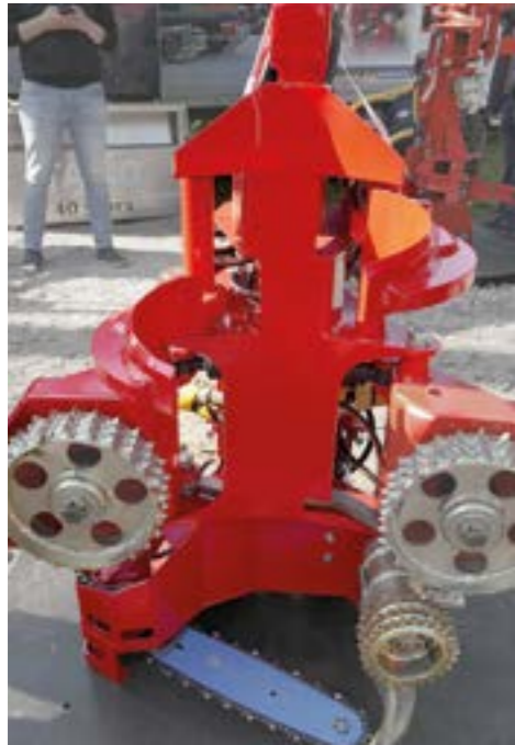
Riittölehdon osastolla Tapio 245 R rullaharvesterin suurin katkaisuläpimita on 250 mm ja karsinta 200 mm. Painoa on ainoastaan 245 kg ja tehontarve 35 kW.
