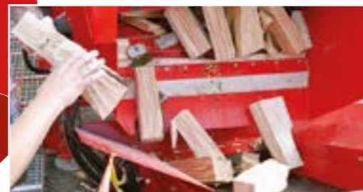
Feed 900 syöttöpöytä kykenee käsittelemään tukkipöydältä tulevia 90 cm paksuja pöllejä.
