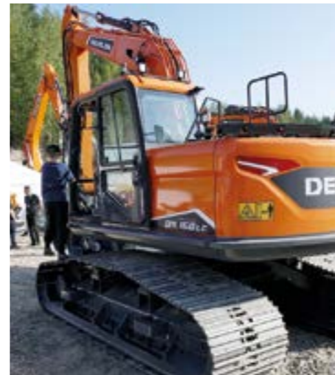
Develon DX 160LC on 900 mm lapuilla varustettu metsäalustainen seisakasrjan kone, jonka suojaimeutokset on tehty Suomessa. Suurin muutos vanhempaan viitossarjan malliin on parantunut etunäkyvyys puomin puolelle, kun moottorin etukotelo on siirretty taaksepäin.
