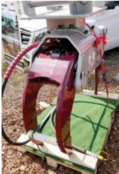
Kenttäsepat Oy:n esittelyssä ollut Bison M300 Pro on riisuttomallinen koura, jonka avauma on 120 cm.
