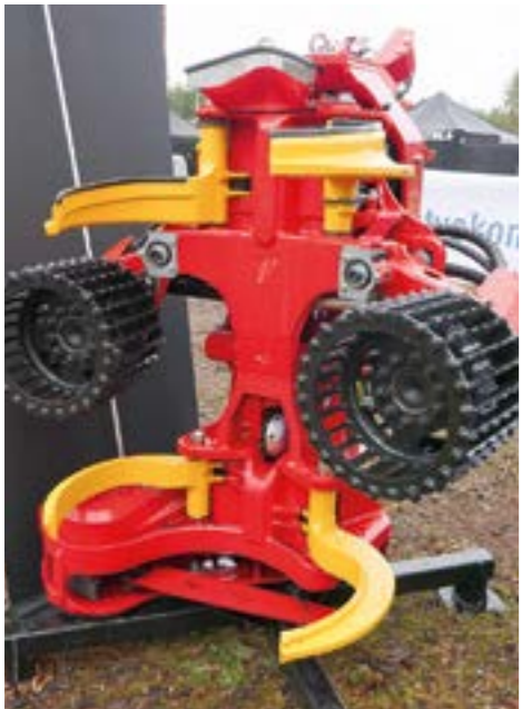
TMK kourasahaan saa terälaitteen, jolloin voi tuoreeltaan halkoa paksut pölliit. Terä voi olla paikoillaan kun puita pätkiessä.
