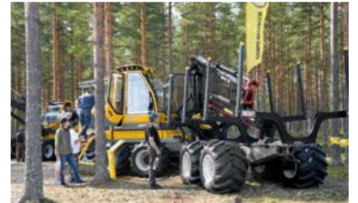
Sampo esitteli myös uusitun kuormatruktorin FR48, kantavuus on noussut 13 tonniin, koneessa levitettävä kuormatila ja kuormaimessa kärkiohjaus.
