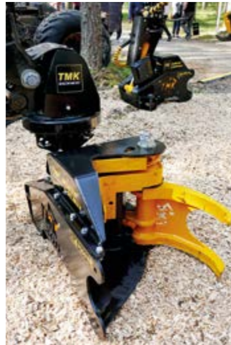
TMK kouran kääntölaite sallii puiden käsittelyn "nurkan takaa". Koura ei siis roiku, joten puut voi ottaa tosi tarkasti. Sähköjohto rajaa nivelen pyörimisen vajaan ympyrän sisään. Demokoneena oli 15-tonninen kaivuri.
