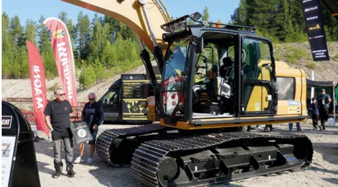
Avescon metsäalustaisessa Cat 317 Next -mallisarjan koneessa on tukisukset molemmin puolin 900 mm leveää telaa ja joka toisessa lapussa kulutusjala. Lisäksi on vaaka, pohjapanssari ja ylävauun kylkisuojat. MEP Steelin alavaunumuutokset nostavat työpainon noin 19 tonniin.
