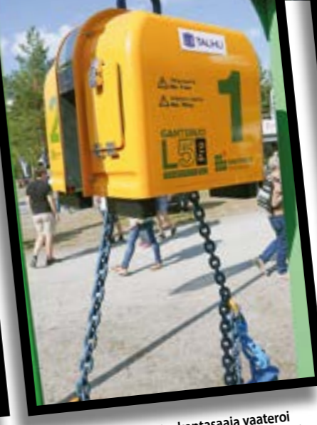
Talhun akkutoiminen taakantasaaja vaateroi raskaita kappaleita ilman useita apumiehiä. Kätevä myös työkonien nostopuomien asennuksessa ja vaihteistojen korjauksissa jopa 20 tn saakka.
