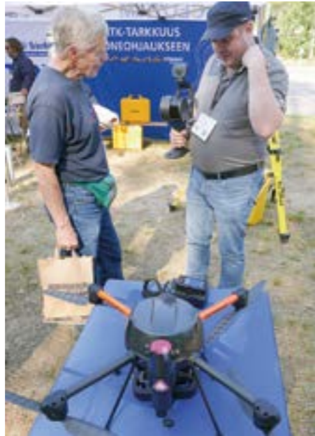
Geotrimin GeoDrone on maanmittauksen, kartoituksen sekä metsä- ja maatalouden sovelluksiin tarkoitettu kuvauskooperi, jonka lentoaika on lähes tunti ja vartti. Se riittää jopa 100 hehtaarin kokoisen alueen ortokuvaamiseen.
