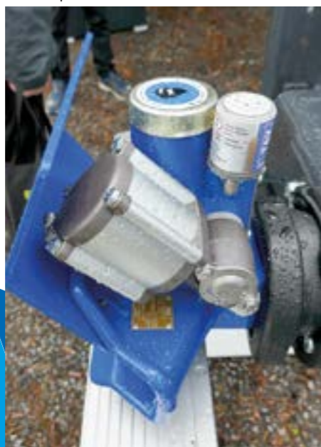
TAV on uusi vahvarakenteinen Dolly-vetokytkin, jonka painoraja apuvaunu- ja keskiakseliyhdistelmissä on 90 tn.
