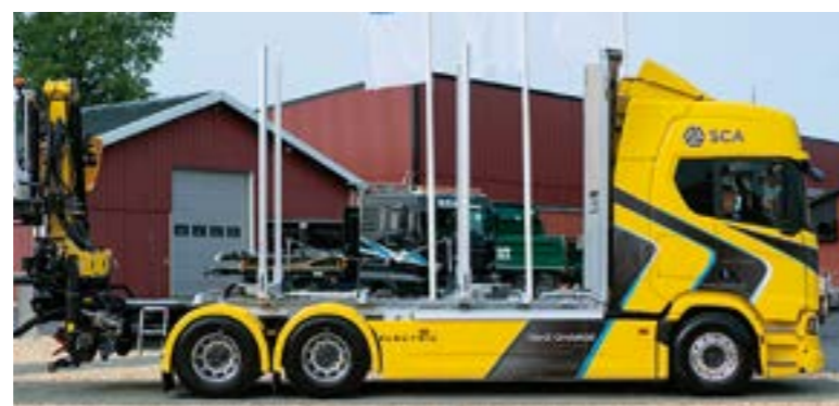
Scania 45 R täyssähköpuutavara-auton akkukapasiteetti on 624 kilowattituntia. Lataus tapahtuu CCS-pistokkeella.
