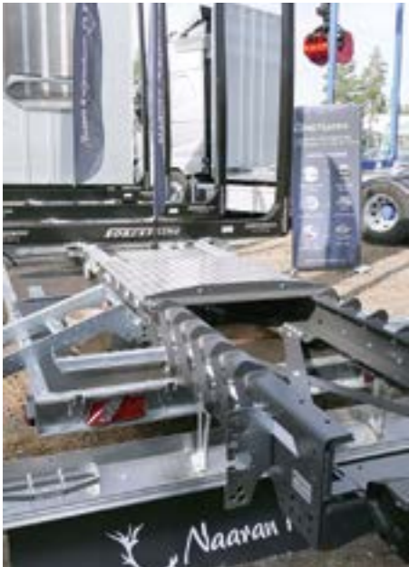
Latvialainen Metsatek on Baltian johtavia päällirakenteiden valmistajia, jota meillä asentaa Naaran Kuljetushuolto Pieksämäeltä. Korrosioherkissä rakenteissa käytetään runsaasti alumiinia.
