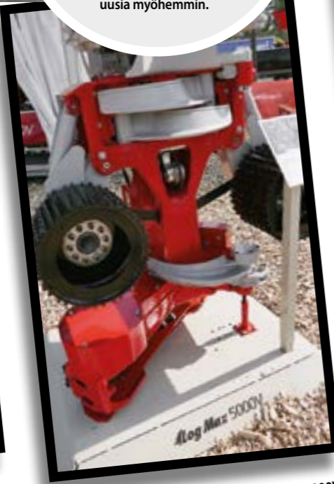
Joukkokäsittelykypäriellä varustettu Log Max 5000V on päivitetty D-mallista. Suurin katkaisuläpimitta on 74 cm.
