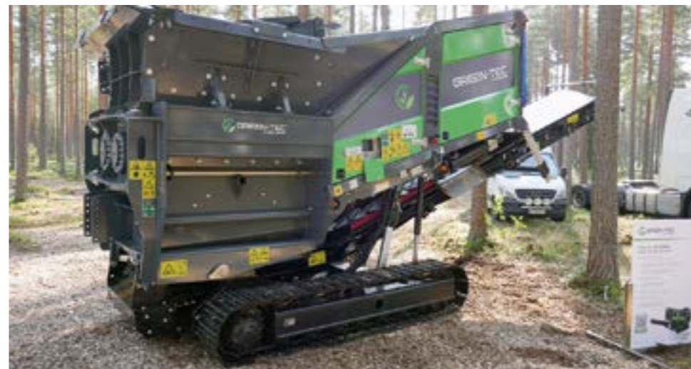
Green-Tec LS2 mobiilimurskaimessa on kaksi 1,5 m pitkää roottoriakselia, jotka saavat käyttövoimansa 140 kW Cat C4.4 -moottorista.
