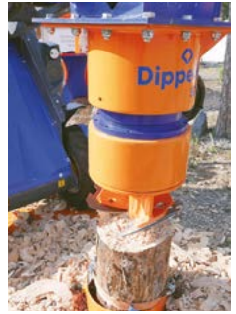
Dibber-kantojyrsimet rouhivat kannot maantason alapuolelle verkkaisella kierrosnopeudella. Kolmesta kokoluokasta suurin on suunniteltu 14-30 tn kaivinkoneisiin.
