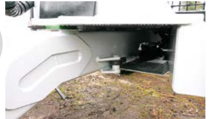
Tukevalla ja vääntöjäykällä kaksoispalkkirungolla toteutettu Hypron 14 tn metsäperävaunu ei välttämättä tarvitse nosturin kanssa lainkaan tukijalkoja.
