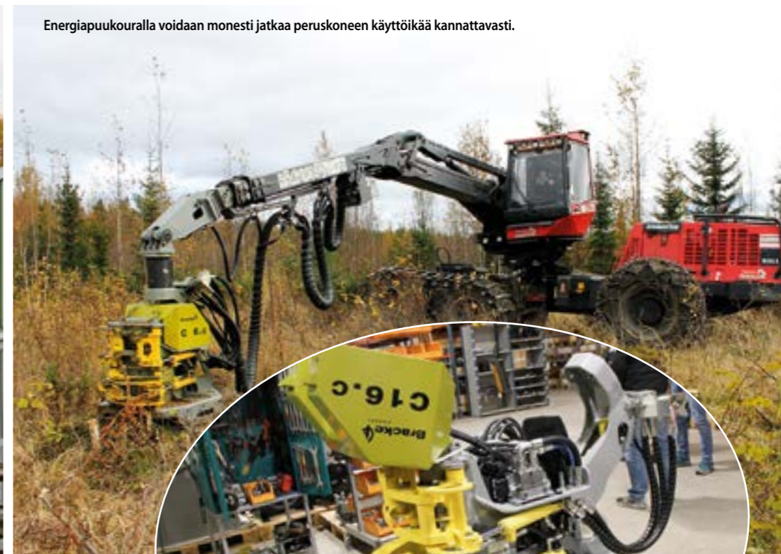
Bracke C16.c energiapuukoura kokoonpanossa tehtaalla.
