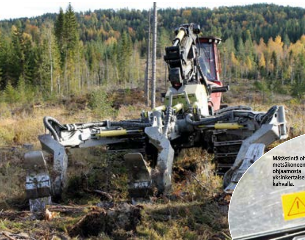
Bracke M36.b mätästaja Komatsu 895 ajokoneen perässä.
