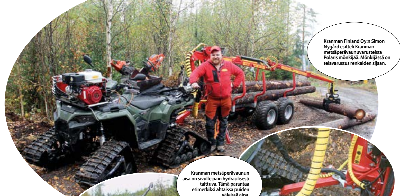
Esillä oli toinen hieman kevyempi ja yksinkertaisempi metsäperävaunuvarustus. Tässä puiden lastaus tehdään käsikäyttöisellä vinssillä vinssaamalla.
