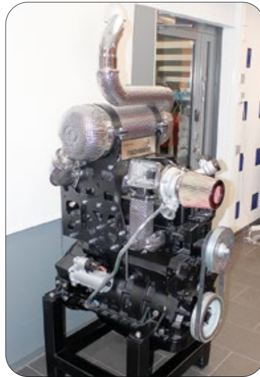
Proventian pakokaasunpuhdistusjärjestelmä uuden traktorin moottorissa.
